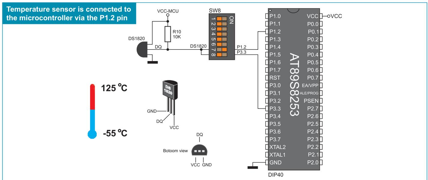
**Figure 8-5:** DS1820 and microcontroller connection schematic
