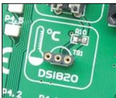
**Figure 8-1:** DS1820 connector (DS1820 is not placed)
