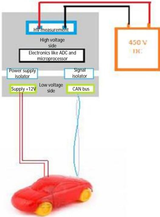
BUILT IN ISOLATION BETWEEN HV SIDE AND LOW VOLTAGE SIDE. UNFORTUNATELY THIS IS NOT AVAILABLE YET. THIS MEANS THAT LOW VOLTAGE GROUND IS ISOLATED FROM HIGH VOLTAGE GROUND.
